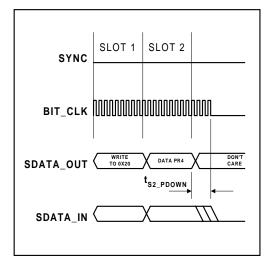
Figure 1 AC-Link Powerdown Timing
