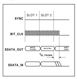
Figure 1 AC-Link Powerdown Timing
